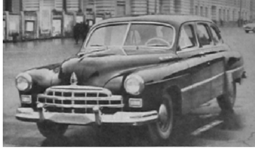
ЗИМ – шестиместный седан, производится на Заводе Молотова в Горьком. По официальной версии, этот шестицилиндровый цельнометаллический автомобиль был запущен с серийное производство уже в 1950.
