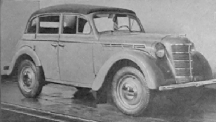
МОСКВИЧ - четырехместный автомобиль малого класса, с расходом топлива порядка 30 миль на галлон по данным русских инженеров. Максимальная скорость этого 1,760-фунтового автомобиля 56 миль в час.
