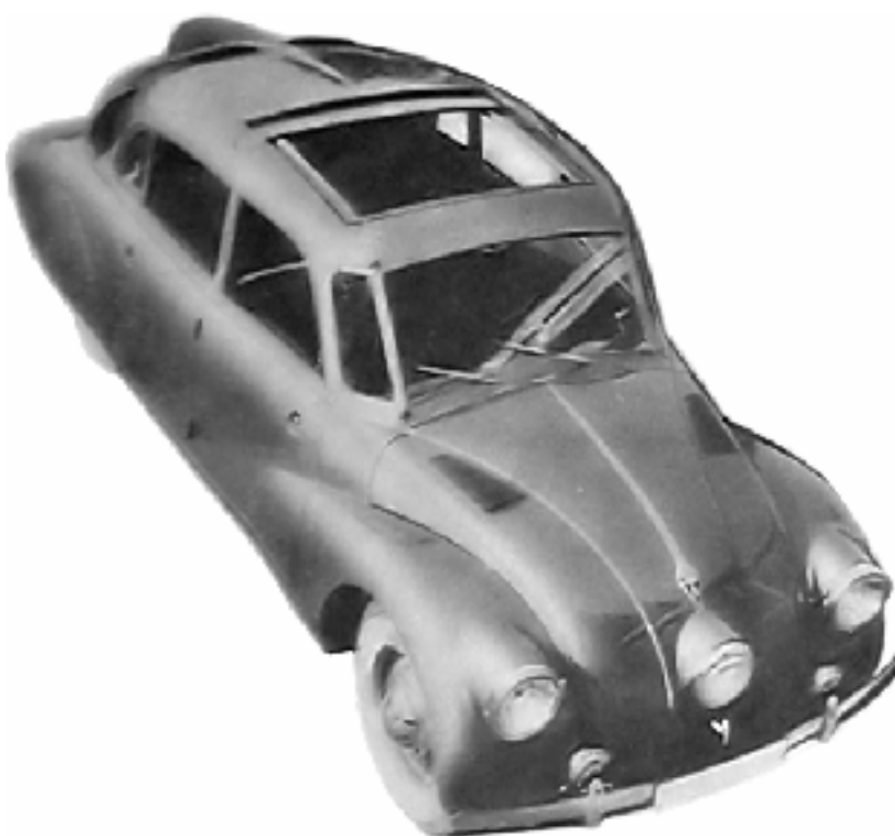
ТАТРАПЛАН - чехословацкая четырехцилиндровая штука. Двигатель воздушного охлаждения находится спереди от задней оси, что приводит к исключительно низкому расположению центра тяжести.
