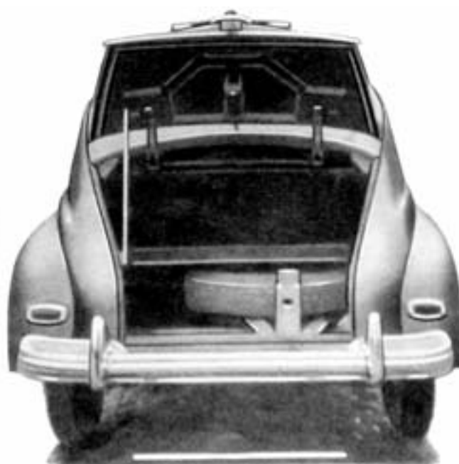
СХОДСТВО с более ранней моделью Стандарт Вангард заметно при виде спереди. На правом рисунке показан большой багажник и запасное колесо, помещенное в отделение под полом багажника.
